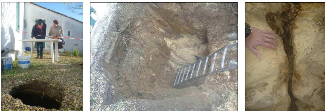
**Figure 13 :** Apparition d'un fontis à LATRESNE (Gironde) lié au déboufrage d'une fissure karstique (visible au fond derrière l'échelle) ayant entraîné les terrains superficiels [Source : Bureau des Carrières de Gironde]
